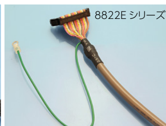
【シールド処理例】 ドレイン線取り付け
